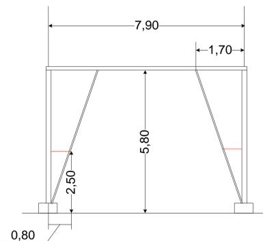
Ограничение строительства по высоте. Колонны отмечены красным.
